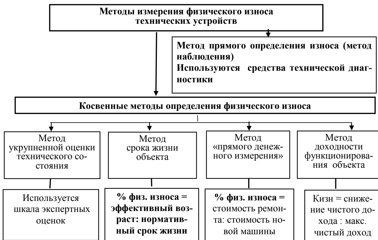
Рис. 2.4. Определение физического износа технических устройств
