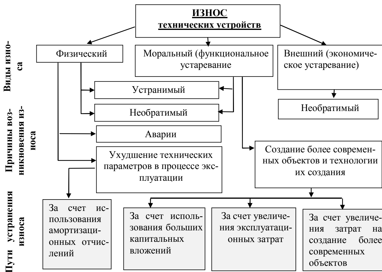
Рис. 2.3. Возникновение и устранение износа технических устройств
