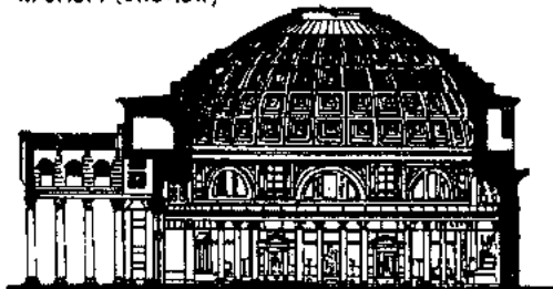
Іл. 3-4. Рим, Пантеон (повздовжній перетин), побудований у 115 – 125 рр. Цей храм, присвячений головним римським божествам, круглий у плані і перекритий напівкруглим кам'яним куполом діаметром 43,6 м із світловим отвором діаметром 8,9 м у центрі склепіння. Товщина стін – 7 м
