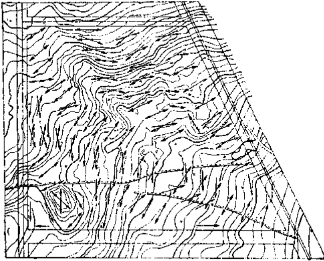
Іл. 10-3. Схема розташування осей будинків з врахуванням рельєфу місцевості (стрілками позначено осі будинків) Джерело: [6, с. 112]
