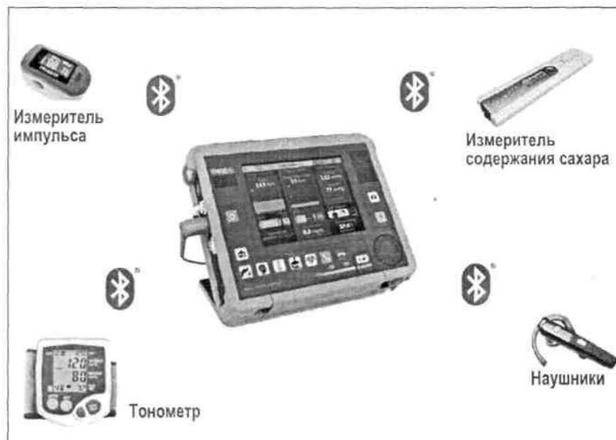
Рисунок 1.14 – Bluetooth Health Device Profile (HDP) призначений для узгодження роботи медичних сенсорів і вимірювальних медичних пристроїв різних виробників [56]
