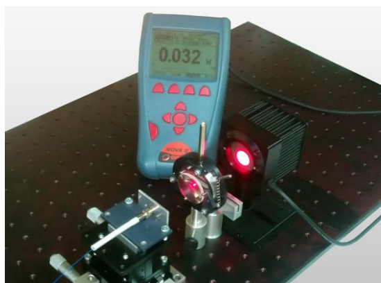
Рисунок 4.12 – Зовнішній вигляд частини установки для вимірювання щільності потужності оптичного випромінювання в паралельному пучку
