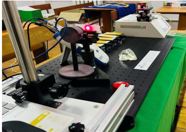
Рисунок 2.5 – Лазерний стенд для визначення коефіцієнту поглинання біотканини в ІЧ (830 нм) та червоному (658 нм)
