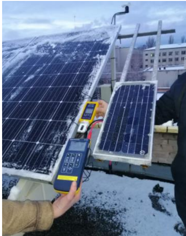
Рисунок 3.10 – Збір інформації для оцінювання ефективності генерування електроенергії даховою ФЕС
