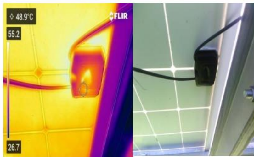
Рисунок 2.8 – Загорання клемної коробки
