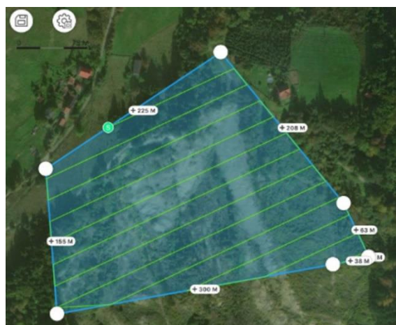
Рисунок В.4 – Приклад траєкторії БПЛА
