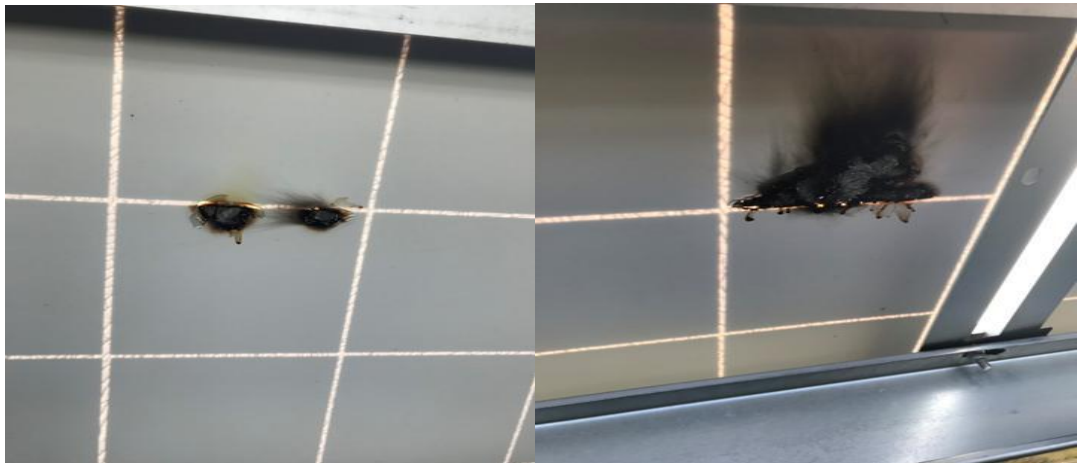
Рисунок 4.3 – Наслідки термічної дії гарячих точок
