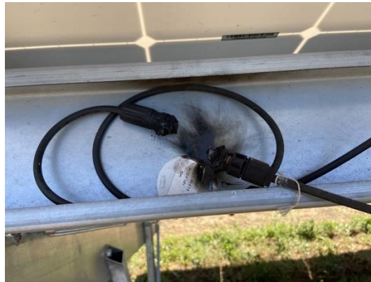
Рисунок В.3 – Пошкодження конектора ФЕМ
