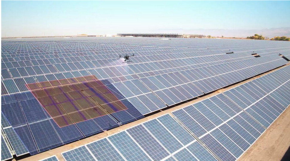
Рисунок 2.3 – Автоматизований візуальний або тепловізійний метод контролю
