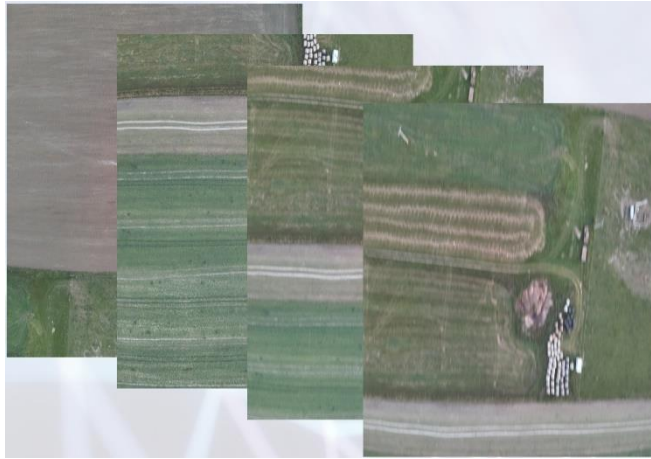
Рисунок В.5 – Приклади накладання знімків БПЛА
