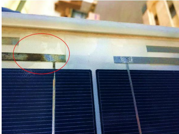
Рисунок 4.5 – Візуальний вигляд відшарування
