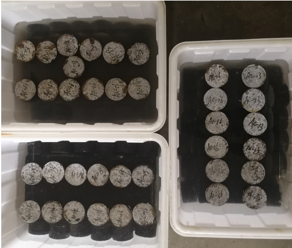
Рисунок 4.1 – Насичення і відтавання зразків асфальтобетону типу АС – 13 і АС – 16 в розчині протижеледних речовин
