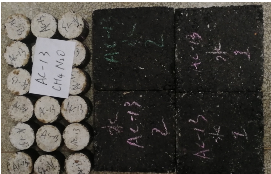
Рисунок 3.2 – Зразки, розміщені на повітрі при кімнатній температурі ( 20 \pm 0,5 ) °C
