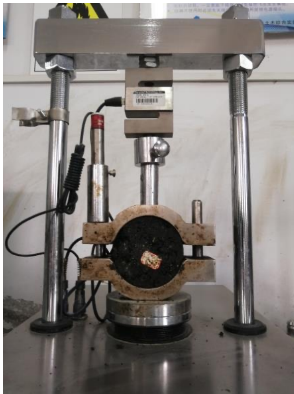
Рисунок 2.6 – Тестер стабільності Маршалла
