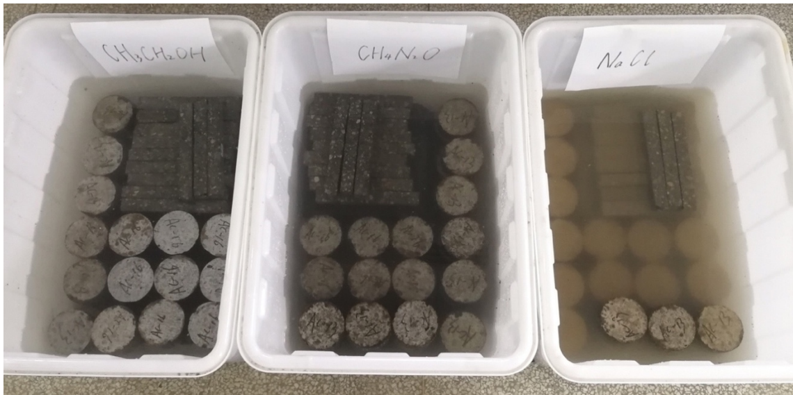
Рисунок 3.1 – Зразки, занурені в розчини протижеледних речовин
