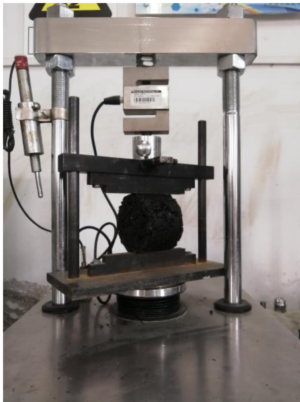
Рисунок 2.7 – Тестер стабільності Маршалла для визначення міцності на розтяг при розколюванні
