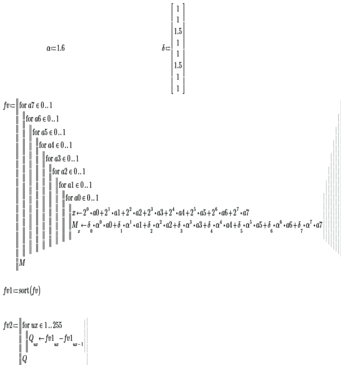
Рисунок 2.8 – Розрахунок у MathCad ділянок нерозривності передатної характеристики ЦАП
