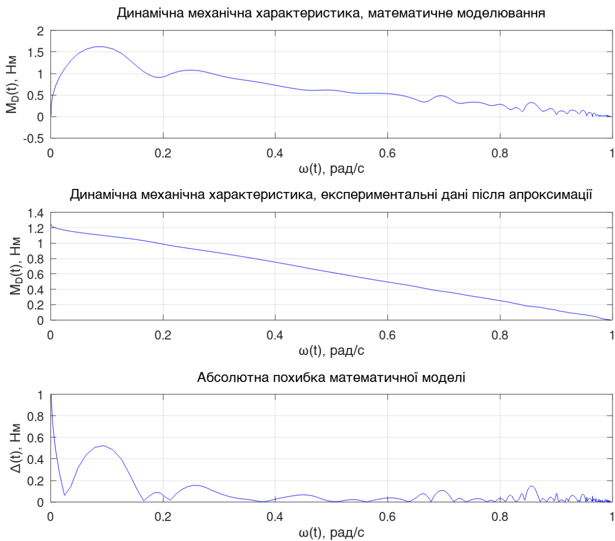
Рис. И.3: Порівняння результатів математичного моделювання динамічної механічної характеристики BMP1002R3NA2A та апроксимованих експериментальних даних
