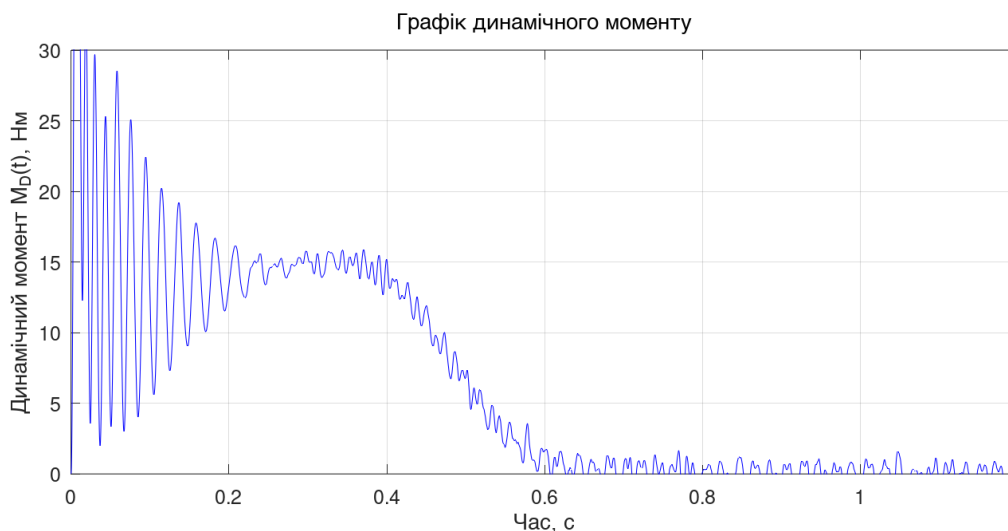
Рис. 5.18: Отриманий під час експериментальних досліджень графік залежності динамічного моменту від часу
