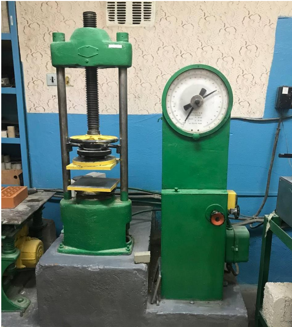
Рисунок 2.9 – Випробувальна установка ПСУ-10
