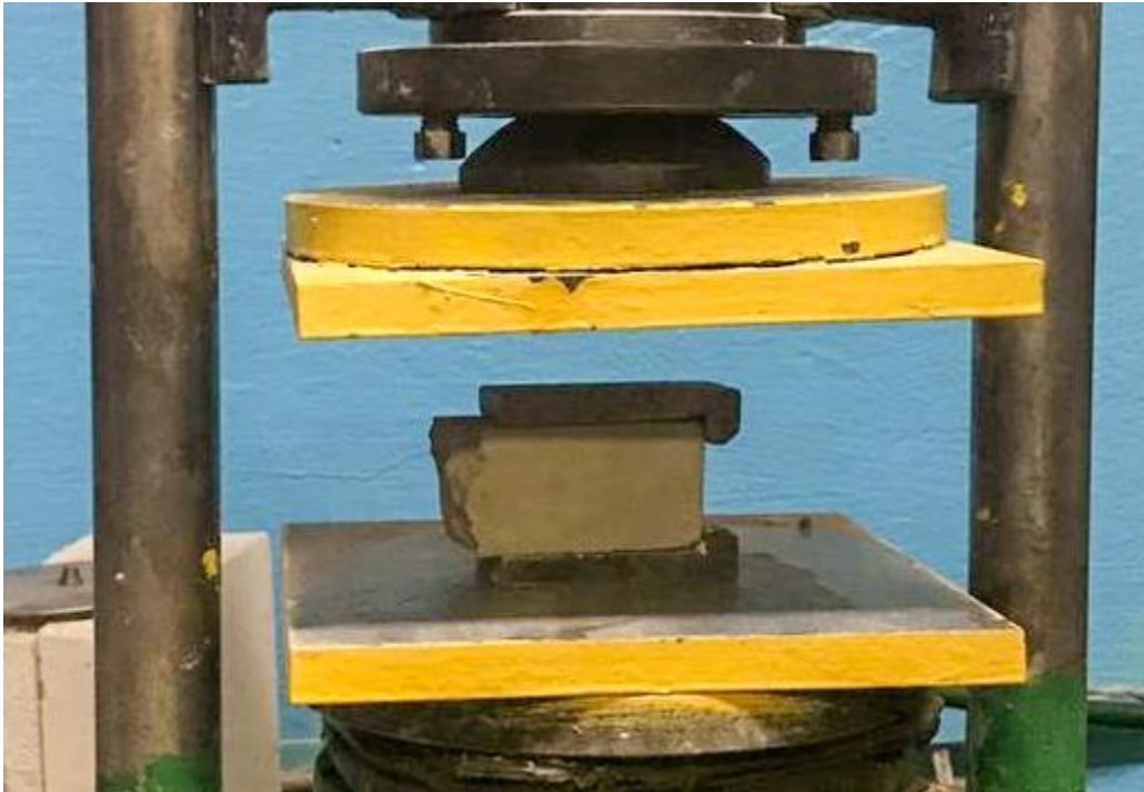
Рисунок 2.10 – Випробування міцності на стиск
