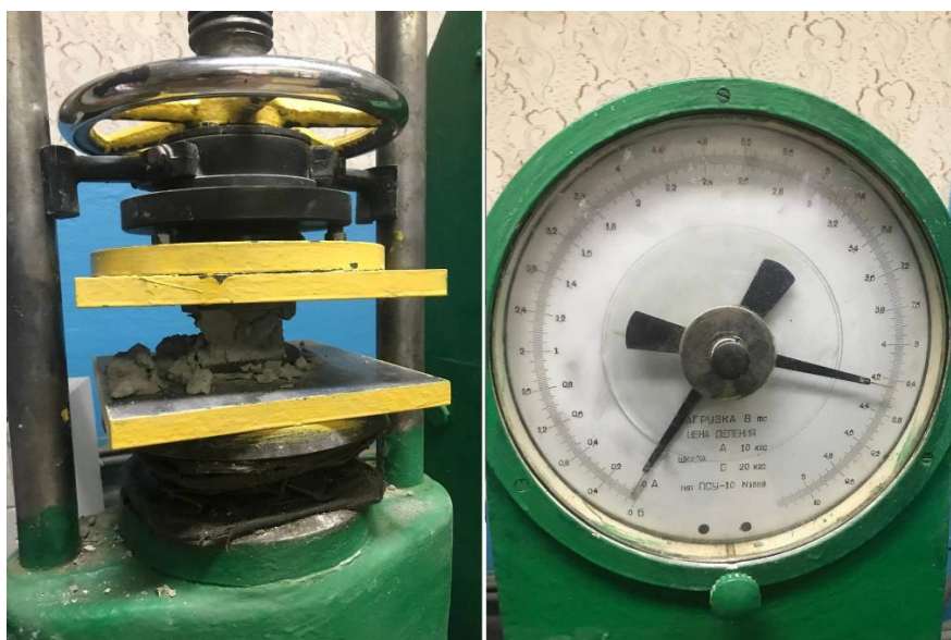
Рисунок 4.4 – Випробування зразків на стиск
