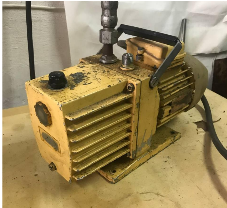
Рисунок 2.6 – Вакуумний насос ЗНВР-1Д
