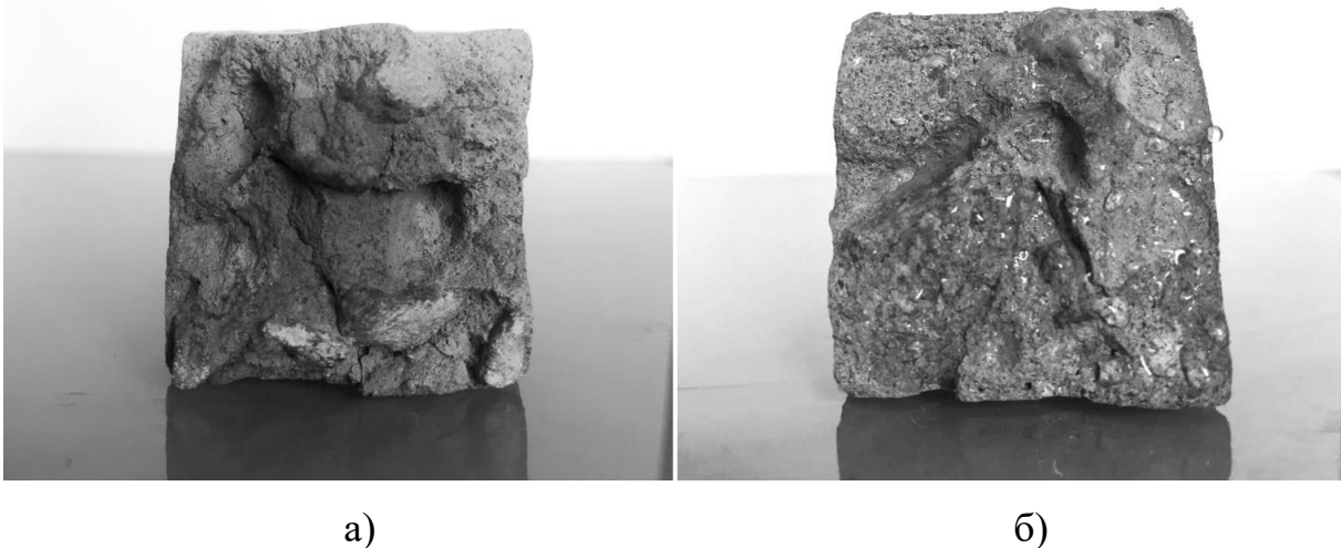
Рисунок 4.1 – Змочені зразки бетону імпрегновані гідрофобізуючим складом:
