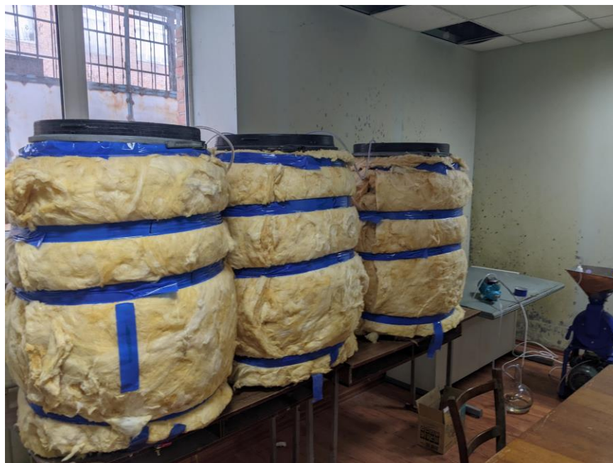
Рисунок Г.1 – Реактори-симулятори сміттєзвалищ у лабораторії Вінницького національного технічного університету
