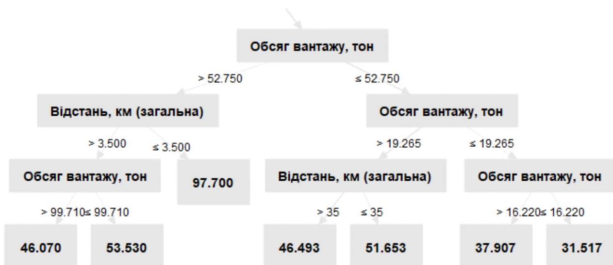
Рисунок Д.9 – Модель RF (Random Forest) випадкового лісу для прогнозування витрат пального транспортними засобами DAF FT XF 105.460 під час доставки зернових культур від сільськогосподарських підприємств до елеватора
