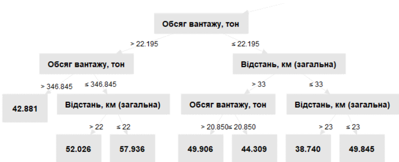
Рисунок Д.5 – Модель RF (Random Forest) випадкового лісу для прогнозування витрат пального транспортними засобами DAF CF85.430 під час доставки зернових культур від сільськогосподарських підприємств до елеватора
