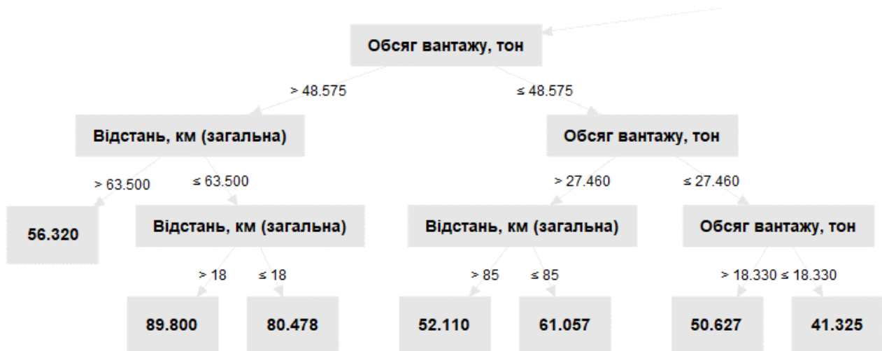
Рисунок Д.2 – Модель RF (Random Forest) випадкового лісу для прогнозування витрат пального транспортними засобами DAF 95.380 під час доставки зернових культур від сільськогосподарських підприємств до елеватора
