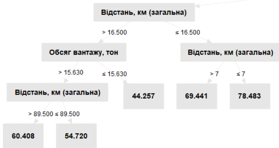
Рисунок Д.1 – Модель RF (Random Forest) випадкового лісу для прогнозування витрат пального транспортними засобами DAF 85.300 під час доставки зернових культур від сільськогосподарських підприємств до елеватора
