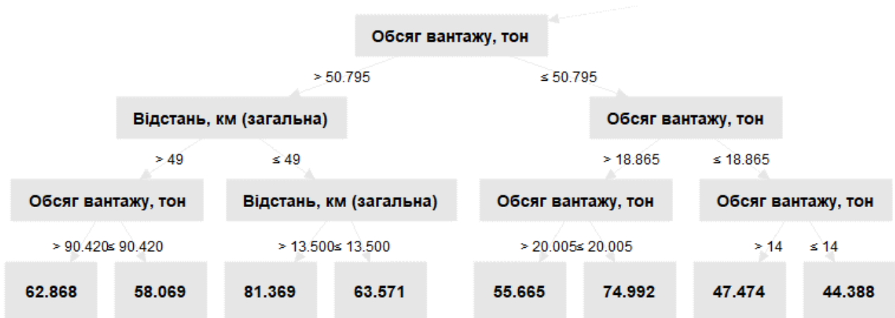
Рисунок Д.3 – Модель RF (Random Forest) випадкового лісу для прогнозування витрат пального транспортними засобами DAF CF85 під час доставки зернових культур від сільськогосподарських підприємств до елеватора
