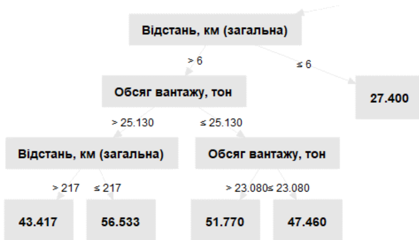
Рисунок Д.4 – Модель RF (Random Forest) випадкового лісу для прогнозування витрат пального транспортними засобами DAF CF85.410 під час доставки зернових культур від сільськогосподарських підприємств до елеватора
