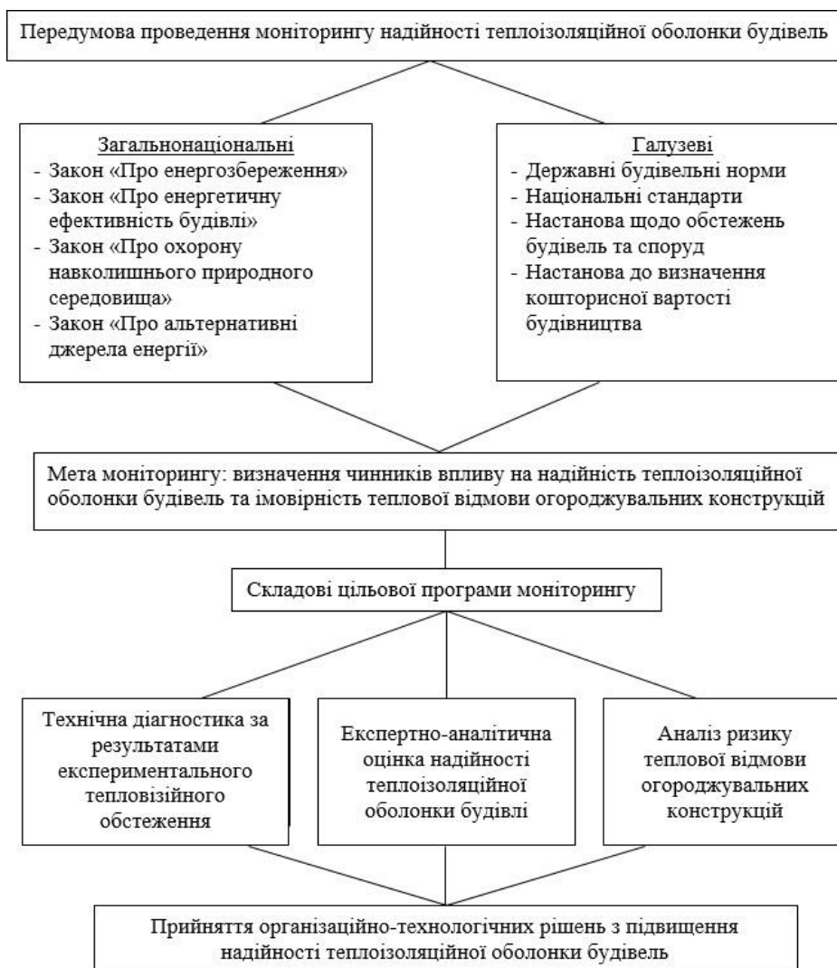
Рисунок 2.1 – Структурна схема концепції проведення моніторингу та експертно-аналітичної оцінки надійності теплоізоляційної оболонки будівель
