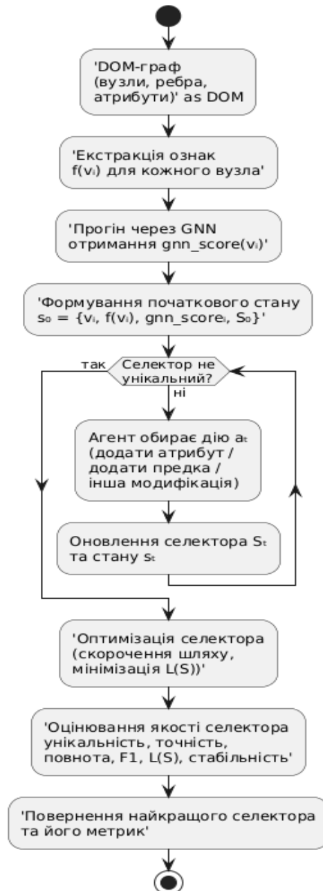
Рисунок 3.13 - Конвеєр обробки DOM-графа GNN-модулем, агентом та підсистемою оцінювання
