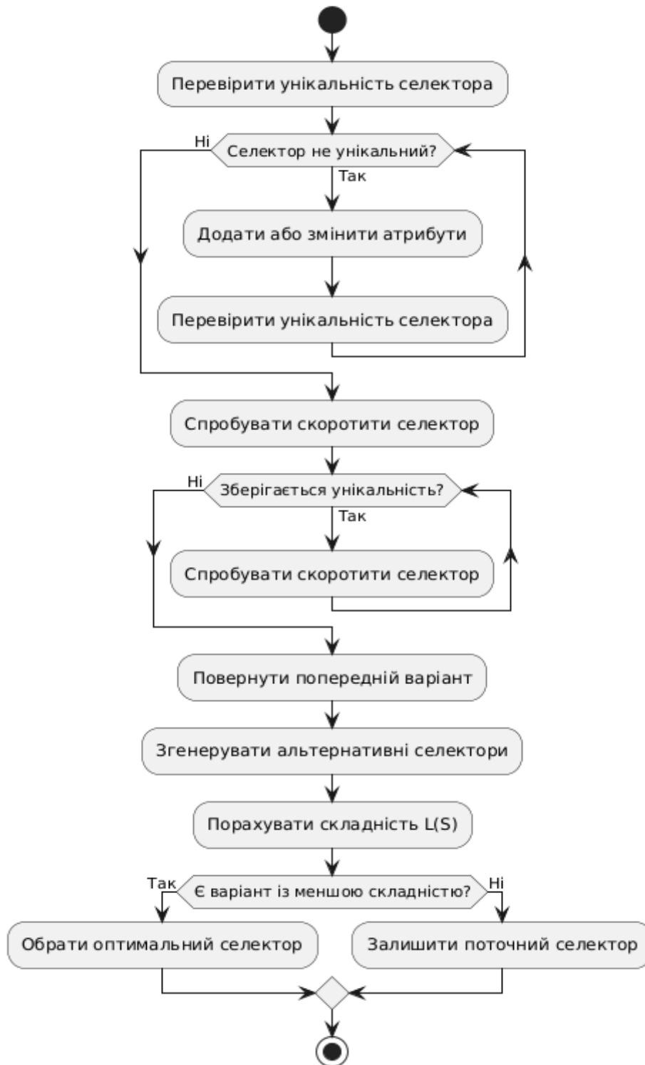
Рисунок 3.8 – Фрагмент алгоритму скорочення довжини та складності селектора
