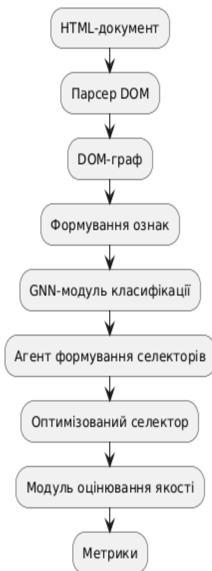
Рисунок 3.1 – Концептуальна модель інтелектуальної інформаційної технології автоматизованого тестування web-орієнтованого ПЗ ІС
