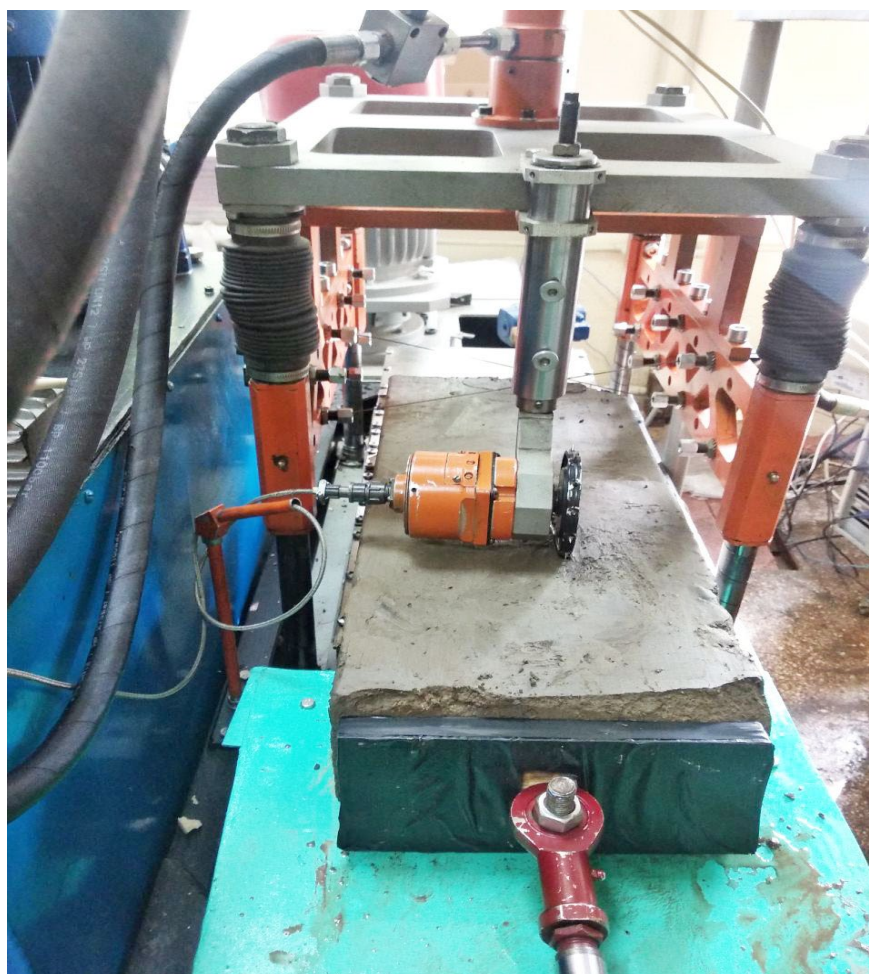
Рисунок 4.21 – Подача глиняного бруса в зону різання установки
