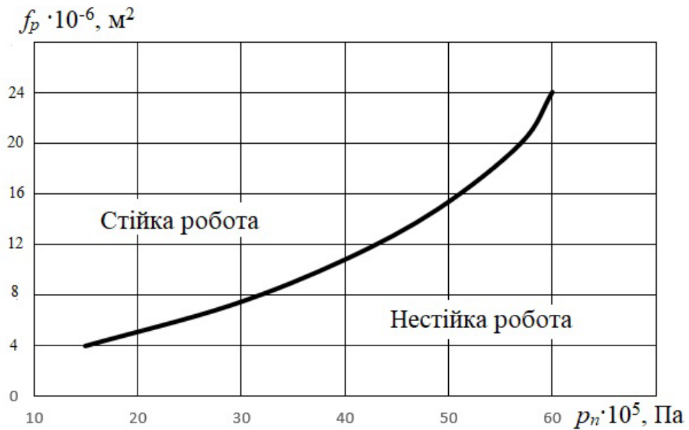
Рисунок 3.14 – Вплив параметрів p_n та f_p на розміщення області стійкості роботи гідроприводу установки.
