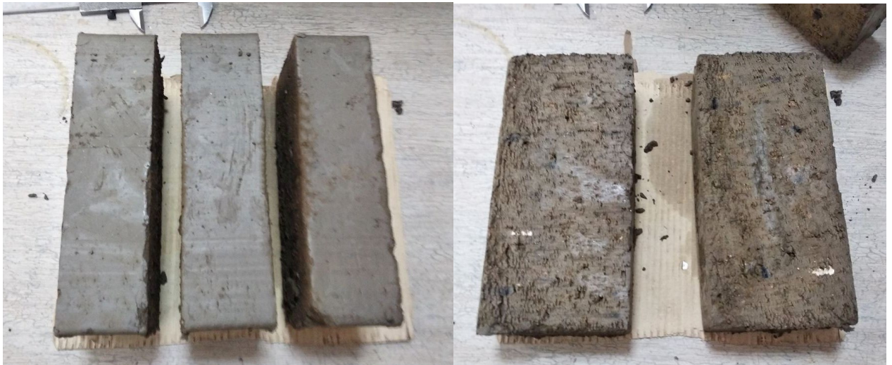
Рисунок 4.15 – Сформовані заготовки цегли
