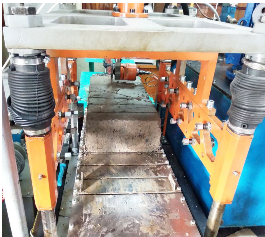
Рисунок 4.23 – Розрізання глиняного бруса (рух траверси знизу вверх)
