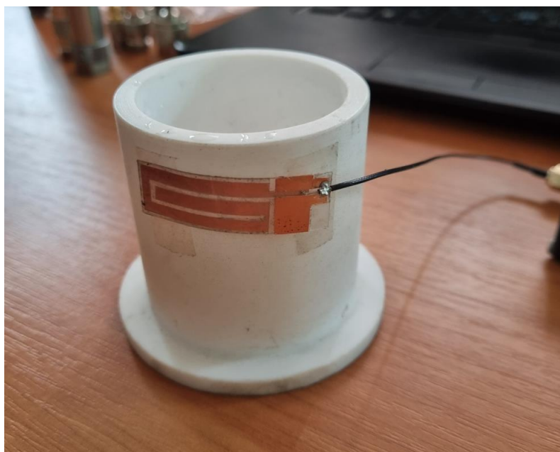
Рисунок 4.11 – Фото гнучкої дводіапазонної LTE антени на бічній поверхні циліндричного тефлонового стакану [31]
