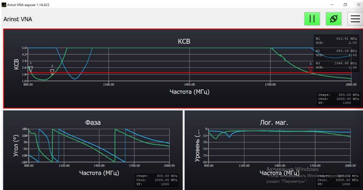
Рисунок 4.15 – Суміщені результати експериментального дослідження хвильових параметрів гнучкої дводіпазонної LTE антени при заповненні тефлонового стакану мінеральною водою (зелена лінія) і гнучкої дводіпазонної LTE антени в повітрі (синя лінія), що отримані автором у роботі [31]
