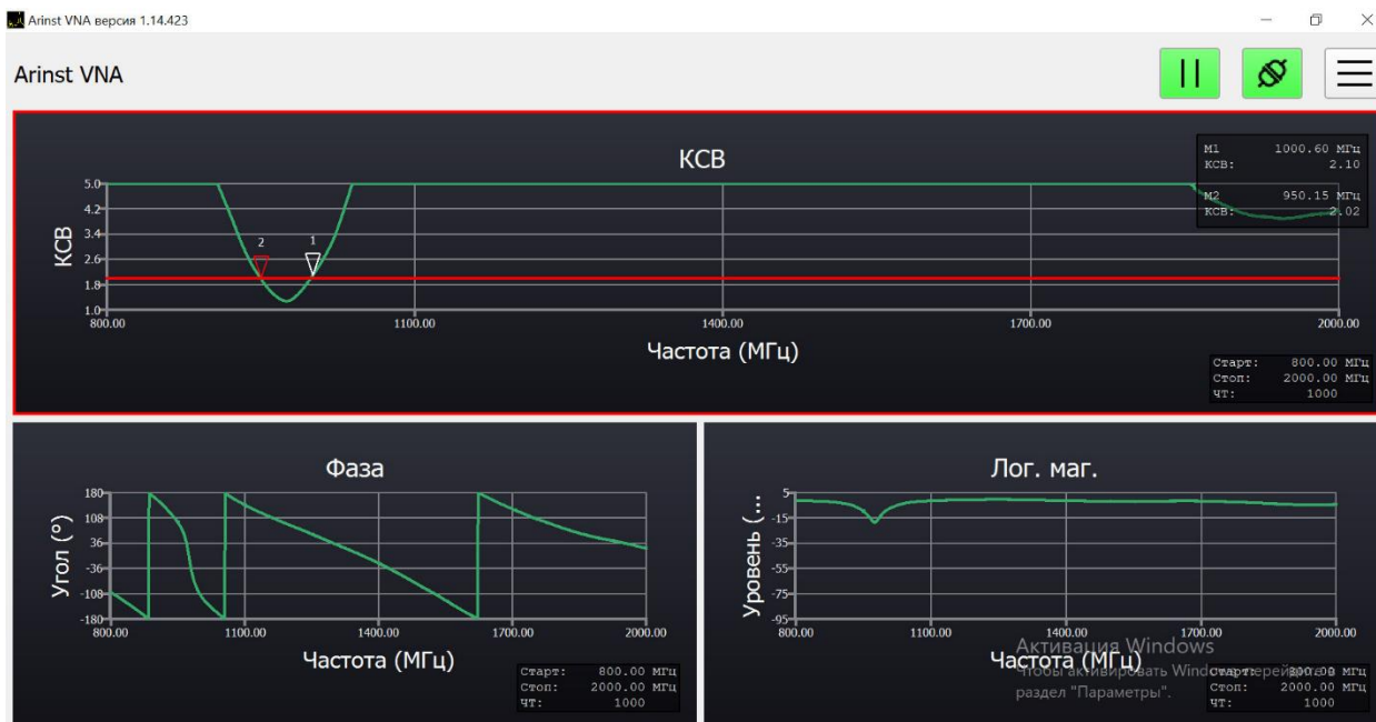
Рисунок 4.12 – Результати експериментальних досліджень гнучкої дводіпазонної LTE антени у повітрі, отримані автором у роботі [31]
