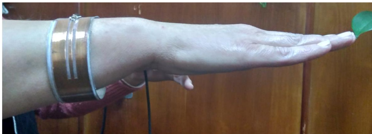
Рисунок 4.34 – Фото гнучкої тридіапазонної LTE антени-браслету в зігнутому положенні на руці людини
