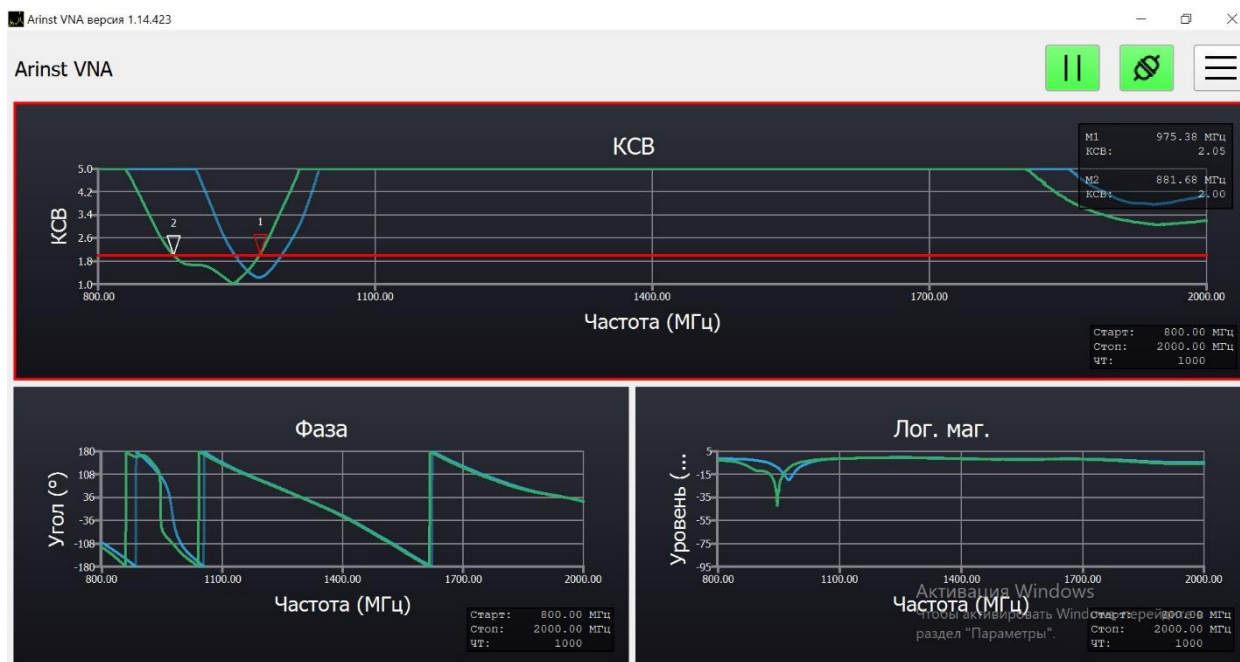
Рисунок 4.14 – Суміщені результати експериментальних досліджень хвильових параметрів гнучкої дводіапазонної LTE антени при опущенні вказівного пальця в тефлоновий стакан по середині (зелена лінія) і гнучкої дводіапазонної LTE антени в повітрі (синя лінія), що отримані автором у роботі [31]
