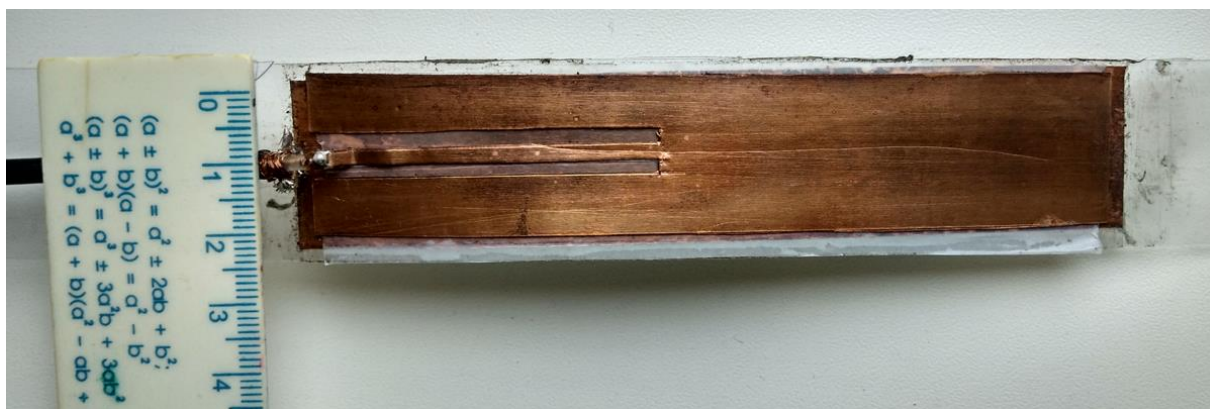
Рисунок 4.31 – Фото експериментального макета гнучкої тридіапазонної LTE антени-браслета та її геометричні розміри
