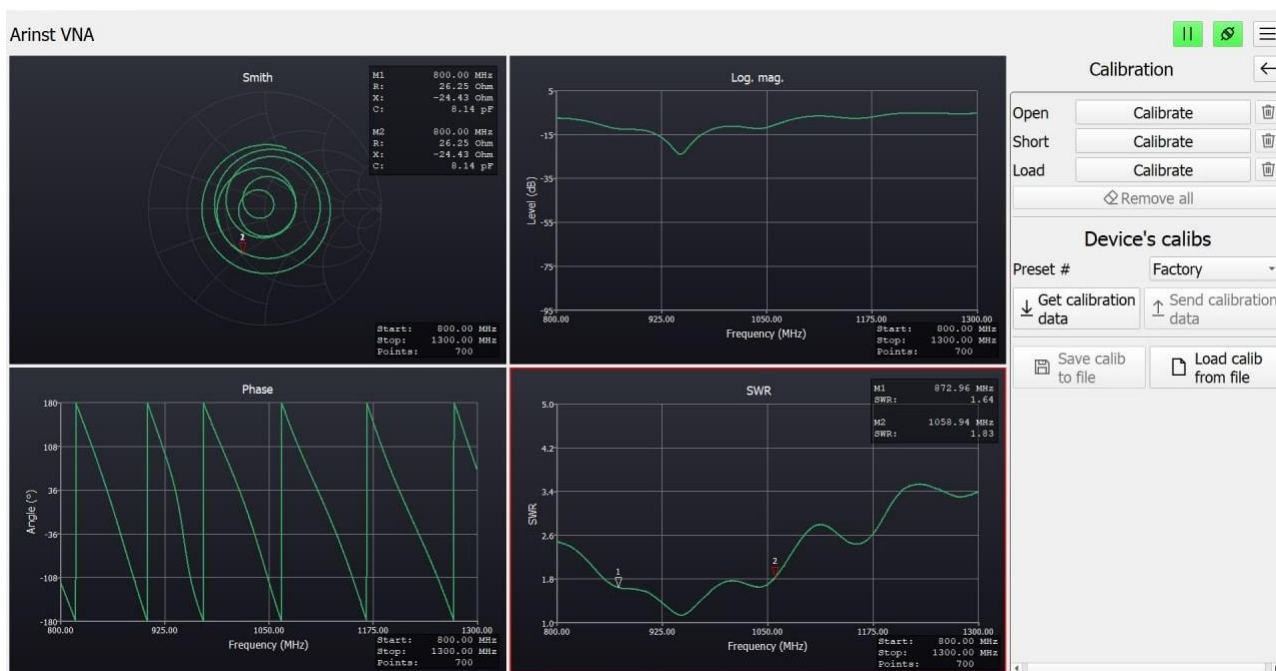
Рисунок 4.33 – Результати експериментальних досліджень гнучкої тридіапазонної LTE антени-браслета
