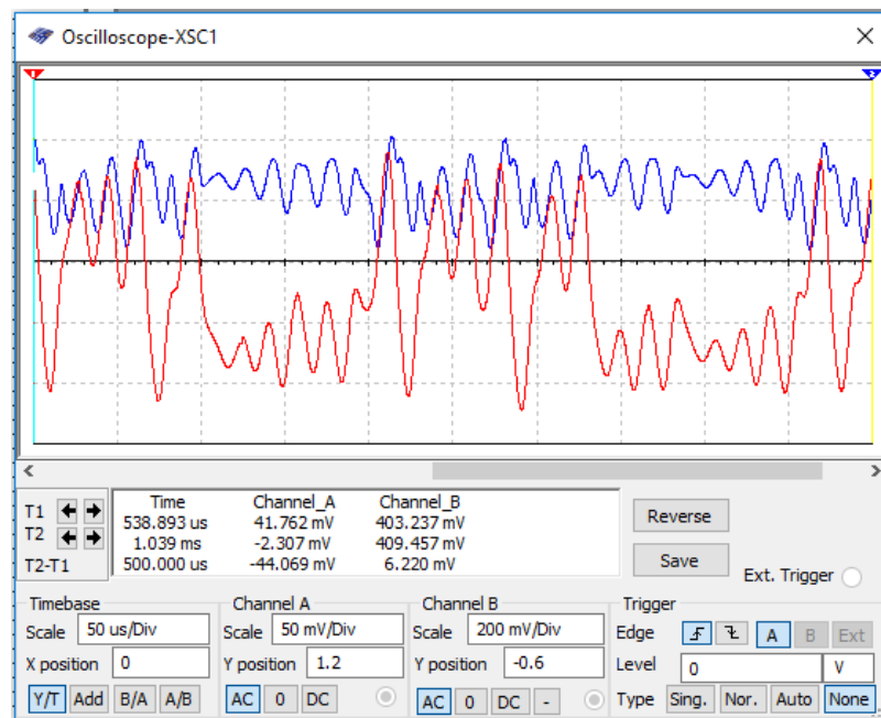
Рисунок 2.20 – Осцилограми генерованих хаотичних напруг простого безіндуктивного RC-генератора сигналів динамічного хаосу на двох біполярних транзисторах
