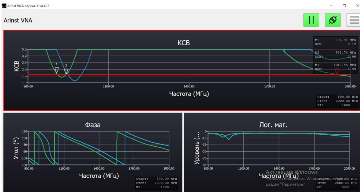
Рисунок 4.13 – Суміщені результати експериментального дослідження гнучкої дводіпазонної LTE антени при її розташуванні у повітрі (синя лінія) та на поверхні тефлонового стакану (зелена лінія), отримані автором у роботі [31]
