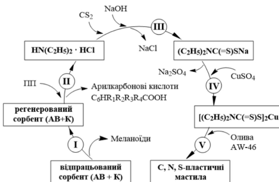
Рис. 3.17. Принципова схема комплексної переробки відходів різних промислових виробництв з отриманням С, N, S-вмісних пластичних мастил:
