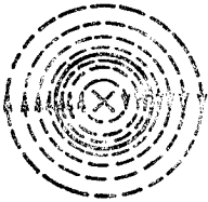
Рис. 14-1. Картина магнитного поля в плоскости поперечного сечения единичного проводника с током.
