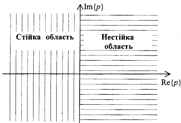
Рис. 2.12. Дозволені і заборонені області для полюса функції H(p) у стійких системах: ліва півплощина (крім осі j\omega ) з \sigma < 0 позначає стійку область; права півплощина (включаючи вісь j\omega ) з \sigma \geq 0 позначає нестійку область
