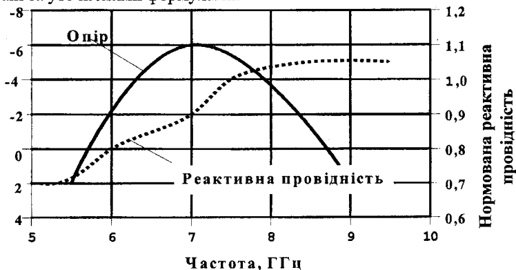
Рис. 3.24. Залежність опору і нормованої реактивної провідності від частоти для структури в режимі інжекційно-пролітного ефекту
