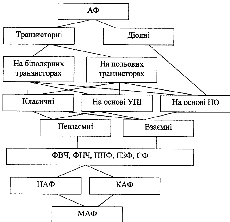
Рис. 3.6. Класифікація активних фільтрів (ФВЧ – фільтр верхніх частот, ФНЧ – фільтр нижніх частот, ППФ – смуго-пропускаючий фільтр, ППЗ – смуго-загороджувальний фільтр)
