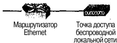
Рис. 5.5. Комбинация точки доступа беспроводной локальной сети и маршрутизатора Ethernet обеспечивает выполнение тех же функций, что и маршрутизатор беспроводной локальной сети
