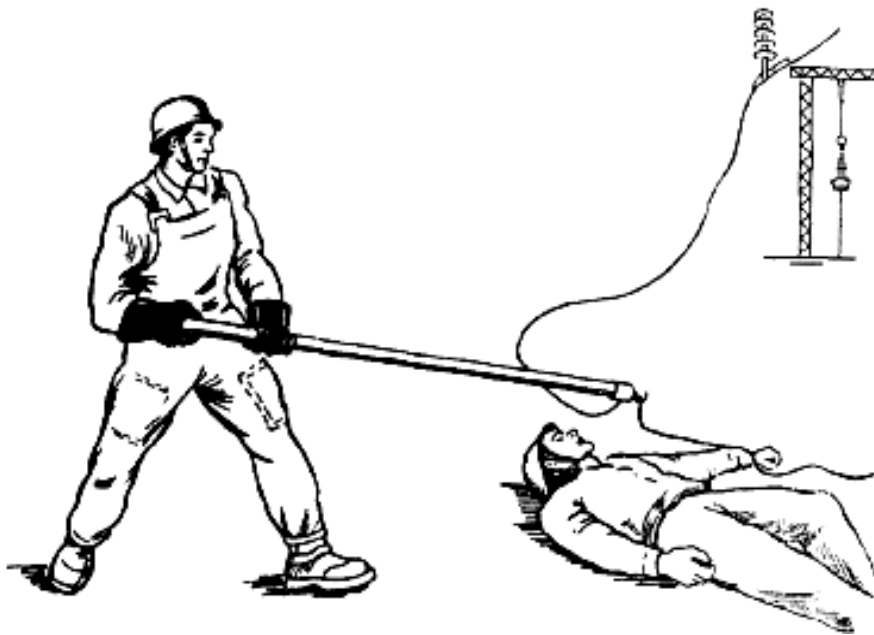
Рисунок 6.16 – Звільнення потерпілого від дії струму в електроустановках напругою понад 1000 В ізолюючою штангою
