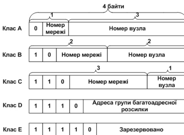
Рисунок 1 – Структура IP-адрес різних класів
