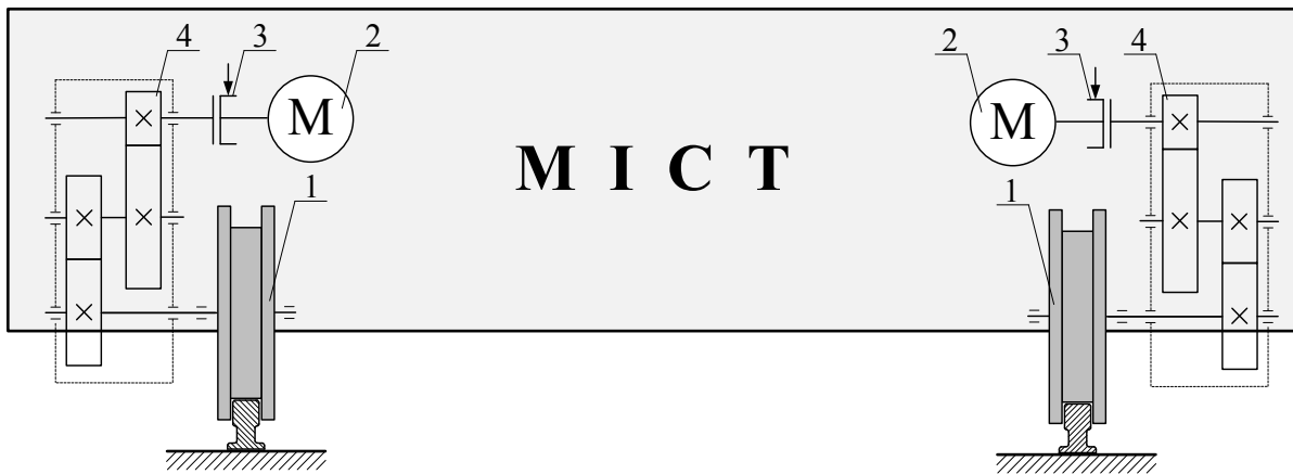
Рисунок А.6 – Кінематична схема механізму переміщення мостового крана
