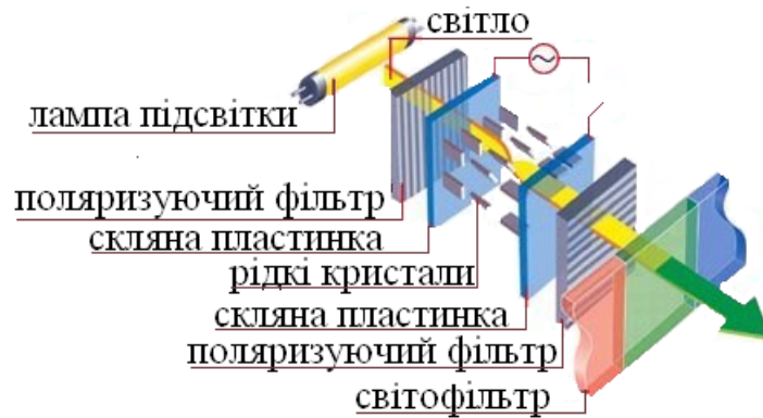
Рисунок 9.7 – Структура LCD екрана
