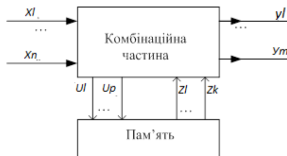
Рисунок 1.6 – Структура складного релейного пристрою
