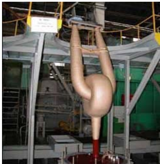
Рисунок 2.9 – U-подібна первинна обмотка
