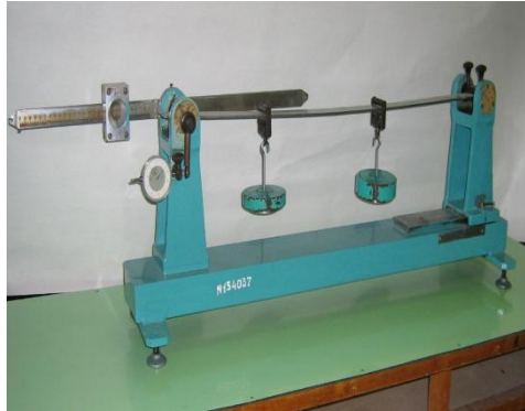
Рисунок 4.7 – Установка для визначення опорного моменту один раз статично невизначуваної балки
