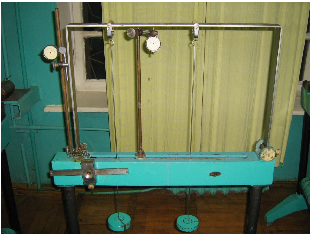
Рисунок 3.4 – Установки СМ-34 для визначення величини прогинів перерізу рами
