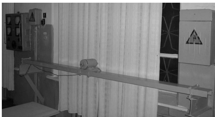
Рисунок 9.3 – Установка для дослідження коливання пружної системи з одним ступенем вільності
