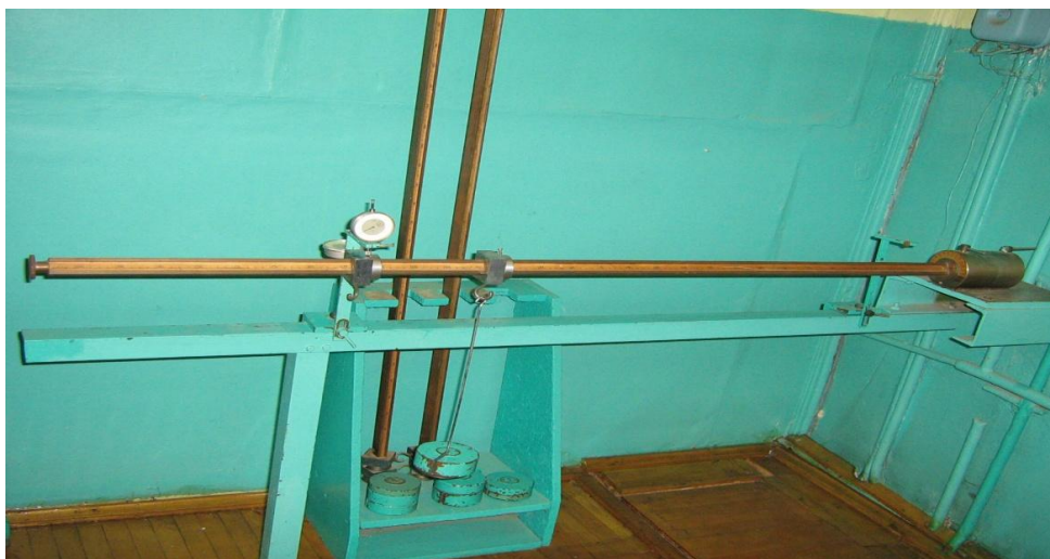
Рисунок 1.2 – Установка для визначення повних прогинів балки
