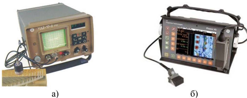
Рисунок 4.2 – Аналогово-процесорний (а) та мікропроцесорний (б) дефектоскопи
