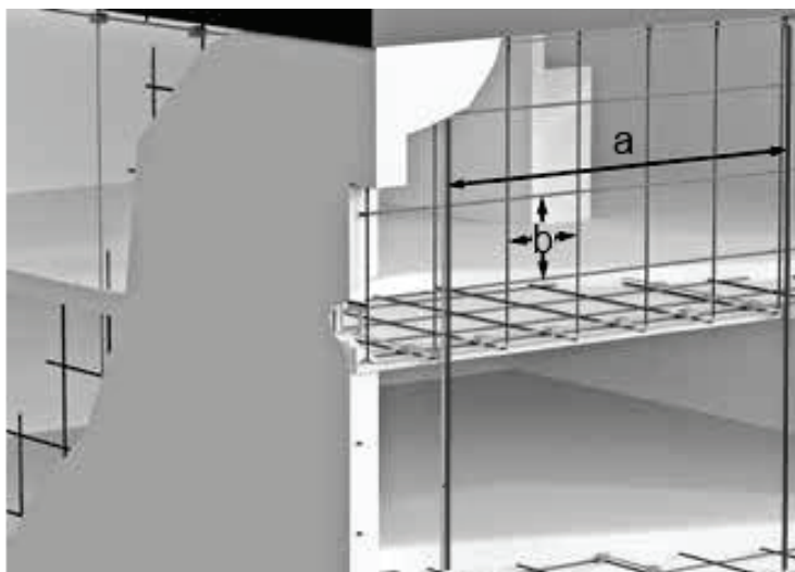
Рисунок 2.20 – Прокладення додаткових струмовідводів в бетонних стінах
