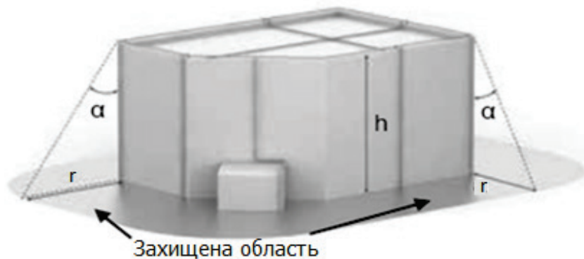
Рисунок 2.7 – Захисна зона блискавкоприймальної сітки
