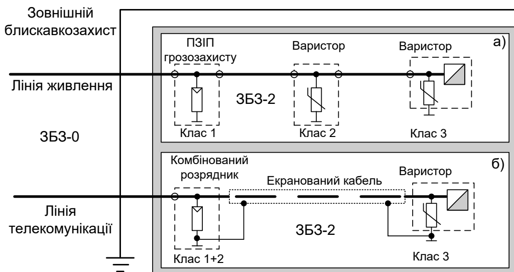
Рисунок 3.10 – Різні типи ПЗП на межі ЗБЗ-0 – ЗБЗ-2
