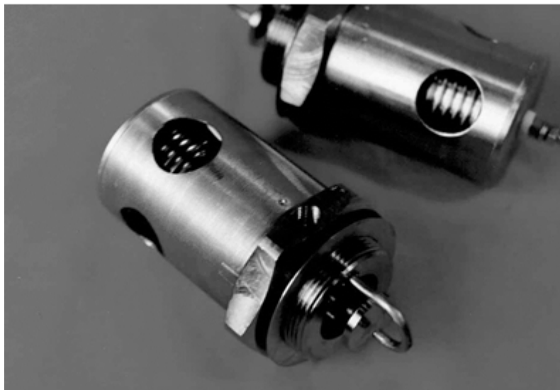
Рисунок 3.46 – Диспергатори для розпилення води у тонкому шарі на частоті 22 кГц, що забезпечують продуктивність 2,5 л/хв
