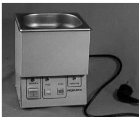
Рисунок 3.62 – Приклади побудови відкритих ультразвукових кавітаційних ванн
