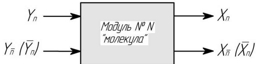
Рис. 7.47 – Схема модуля: Y_n – керівна команда основної дії, Y_{\bar{n}} – керівна команда оберненої дії, X_n – сигнал контролю основної дії, X_{\bar{n}} – сигнал контролю оберненої дії, n – номер модуля
