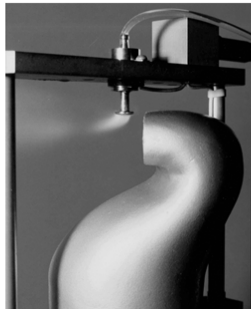
Рисунок 3.18 – Диспергатор з напрямним апаратом для отримання великого за площею факела розпилення
