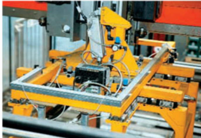
Рисунок 7.22 – Приклад застосування системи розпізнавання зображень при сортуванні пляшок на лінії компанії Eisenmann AG [56]
