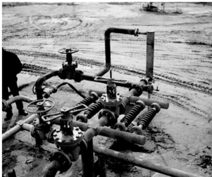
Рисунок 3.60 – Ультразвукова проточна кавітаційна установка, що встановлена на нафтодобувній свердловині НГВУ “Чернігівнафтогаз” нафтового родовища в м. Прилуки
