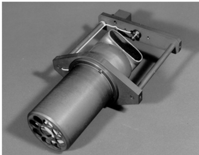
Рисунок 3.49 – Ультразвуковий диспергатор, що утворює факел розпилення діаметром 3 м
