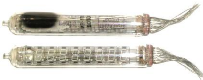
Рисунок 4.7 – Конструкція корпусу (а), зовнішній вигляд (б) ИВ-18
