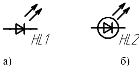
Рисунок 3.3 – Позначення на схемі: а – без корпусу, б – у корпусі
