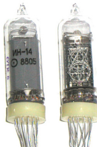
Рисунок 4.5 – Газорозрядний індикатор ИН-14: конструкція (а) та зовнішній вигляд (б)
