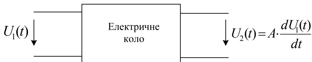
Рисунок 7.1 – Електричне коло, що виконує операцію диференціювання
