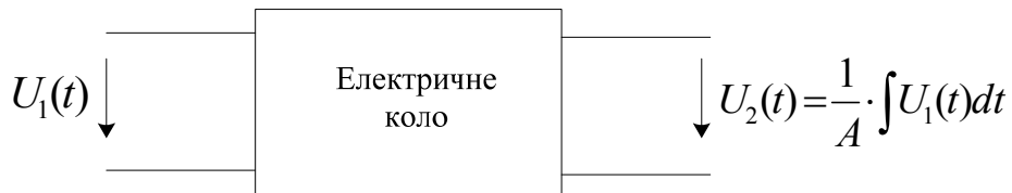
Рисунок 7.7 – Електричне коло, що виконує операцію інтегрування
