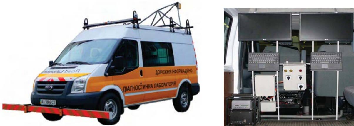
Рисунок 3.2 – Загальний вигляд та місце оператора ЛВС-3 на автомобілі «Ford Transit» [7]
