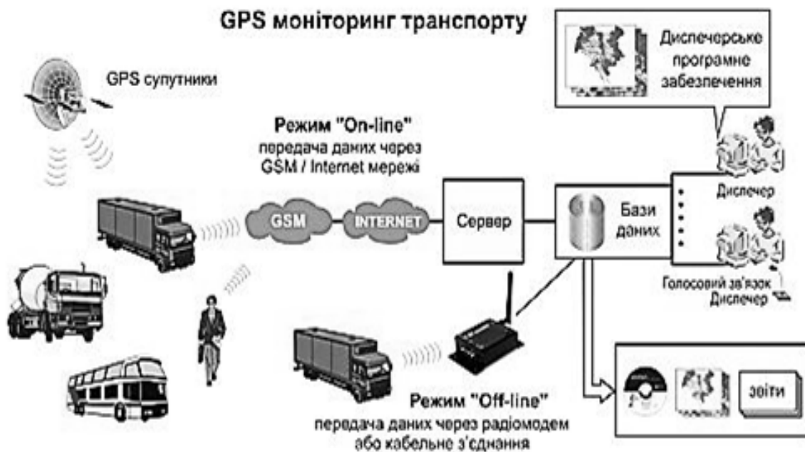
Рисунок 6.7 – Схема дії GPS/GSM моніторингу [10, 15, 18]
