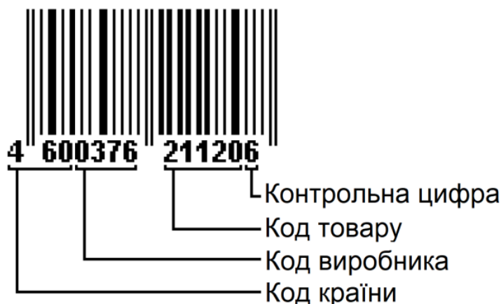
Рисунок 8.4 – Склад коду EAN-13 [5]
