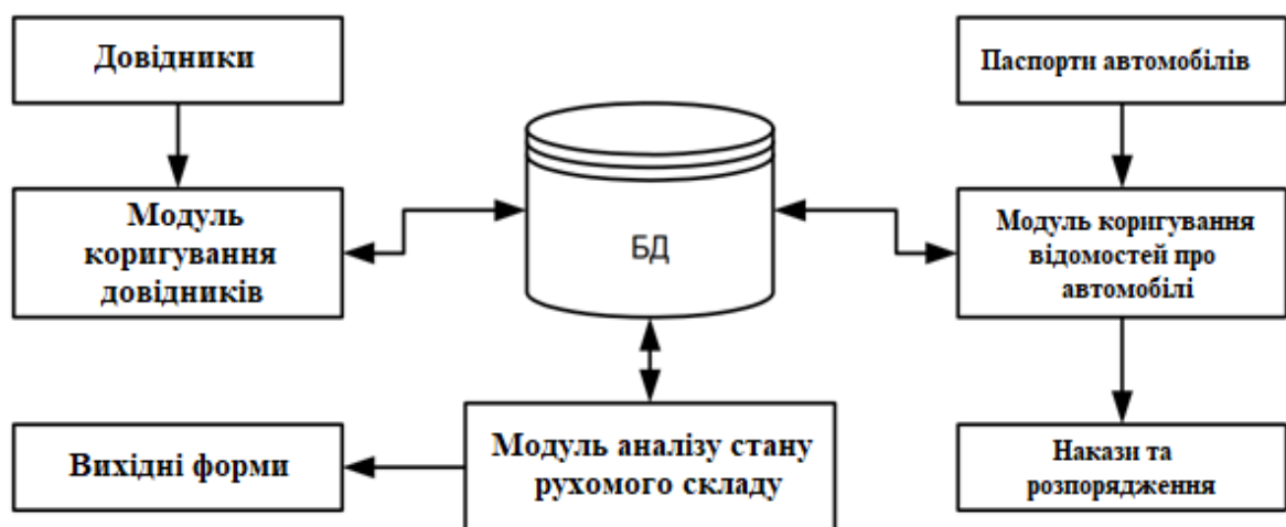
Рисунок 5.3 – Функціональна схема АРМ технічного відділу [10]
