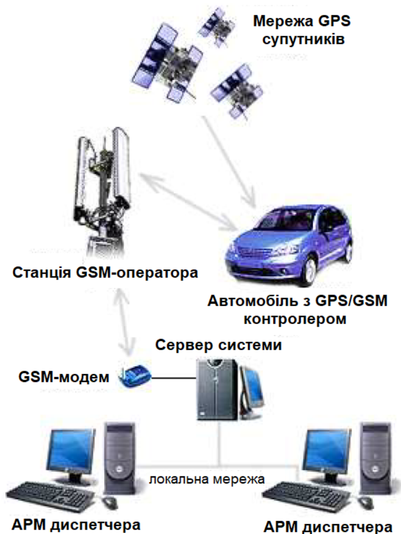
Рисунок 11.5 – Схема доставки даних про місцезнаходження автомобіля за допомогою мобільного зв'язку і власного диспетчерського пункту [5]
