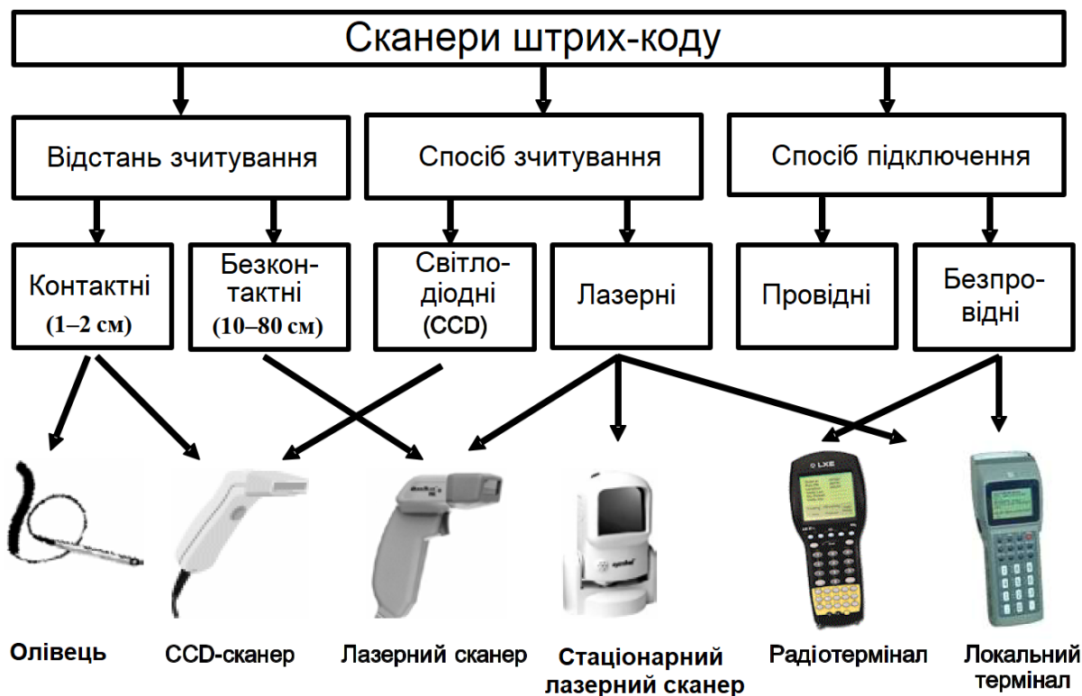
Рисунок 8.6 – Класифікація сканерів штрих-кодів [5, 21]
