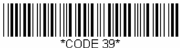
Рисунок 8.2 – Вигляд штрих-коду Code 39
