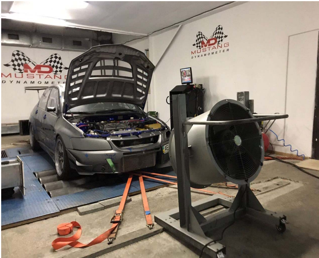
Рисунок 6.2 – Діагностування тягових якостей автомобіля
