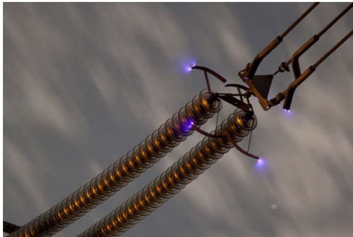
Рисунок 3.6 – Коронний розряд на конструктивних елементах повітряної лінії
