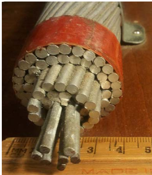
Рисунок 2.16 – Зовнішній вигляд багатодровових проводів повітряних ліній електропередавання
