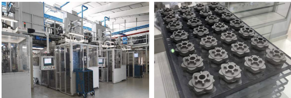
Рисунок 6.10 – Обладнання для 3D-друку Binder Jetting (зліва) та надруковані деталі (справа)
