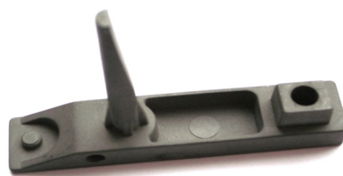
Рисунок 3.19– Зменшення маси виробу ІЛП порівняно з машинною обробкою за рахунок утворення додаткових елементів
