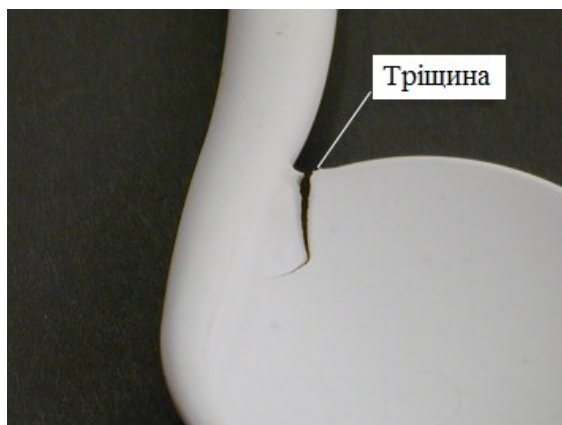
Рисунок 7.12 – Тріщина, яка сформувалась під час спікання хірургічного інструмента із діоксиду алюмінію ( \text{Al}_2\text{O}_3 ). Велика довжина тріщини свідчить, що вона сформувалась до того, як заготовка набула міцності.
