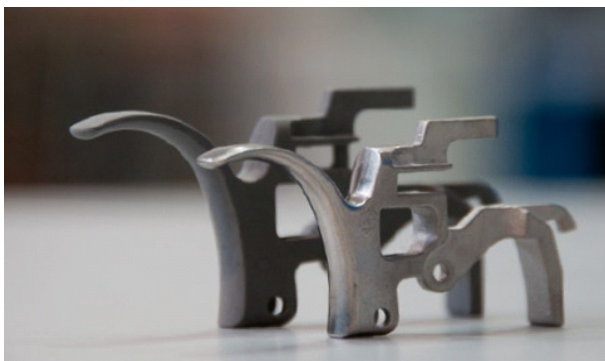
Рисунок 1.40 – Спусковий гачок, виготовлений з титану за технологією ІЛП (в зеленому та спеченому станах). Виробник: MimestoSpA, Італія
