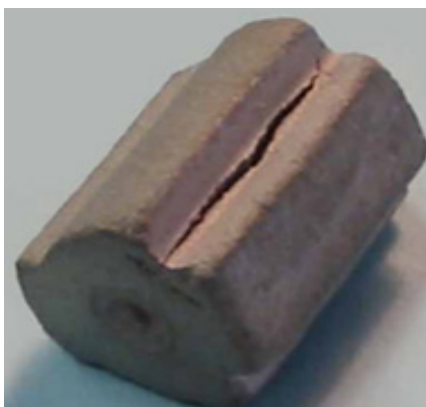
Рисунок 7.7 – Тріщини у вольфрамовому вібраторі для зубної щітки, які виникли через залишкові напруження внаслідок швидкого охолодження і високої молекулярної ваги зв'язувальної речовини
