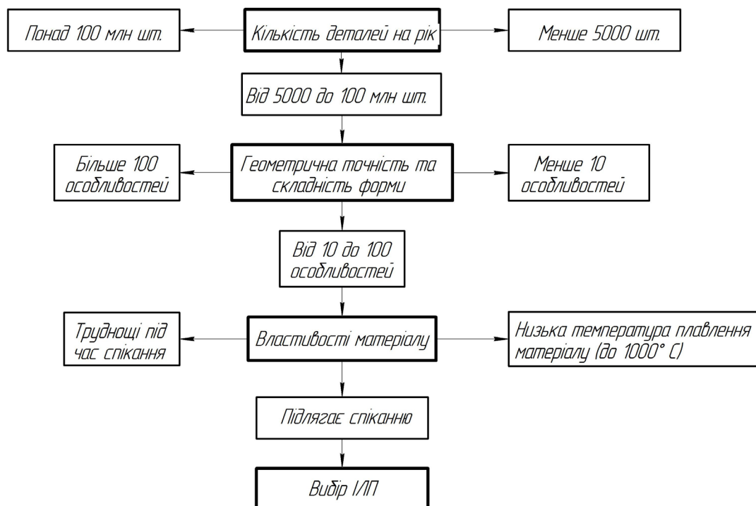
Рисунок 3.1 – Схематичне дерево прийняття рішень доцільності застосування ІЛП
