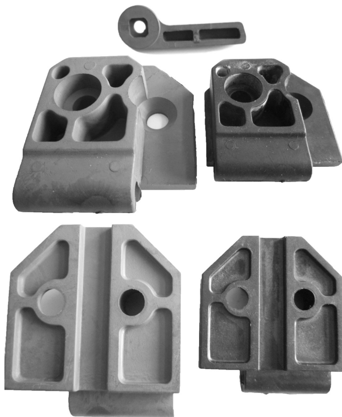
Рисунок 3.27 — Деталі кріплення прикладу автоматичної зброї, виготовлені за технологією ІЛП.
