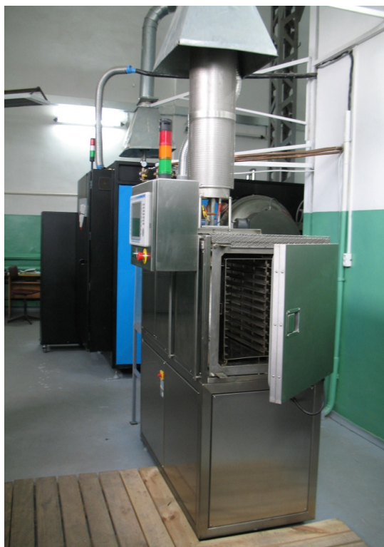
Рисунок 4.6 – Піч для видалення зв'язувальної речовини фірми Elnik Systems (США)
