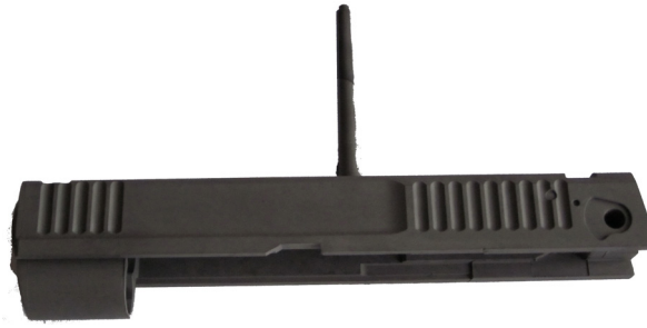
Рисунок 4.21 – Відливок деталі пістолета з приєднаним до неї ливником
