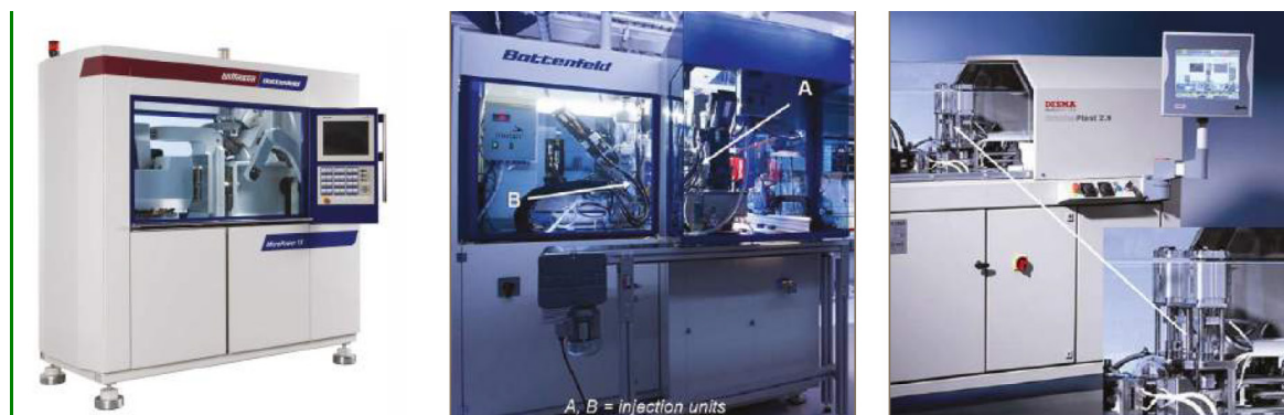
Рисунок 6.3 – Три приклади інжекційних машин для мікроІЛП з плунжерною системою: машина MicroPower15, виробник Witmann Battenfeld (зліва); 2C Mictosystem 50, Karlsruhe Institute of Technology (центр); FormicsPlast, DESMA (справа)
