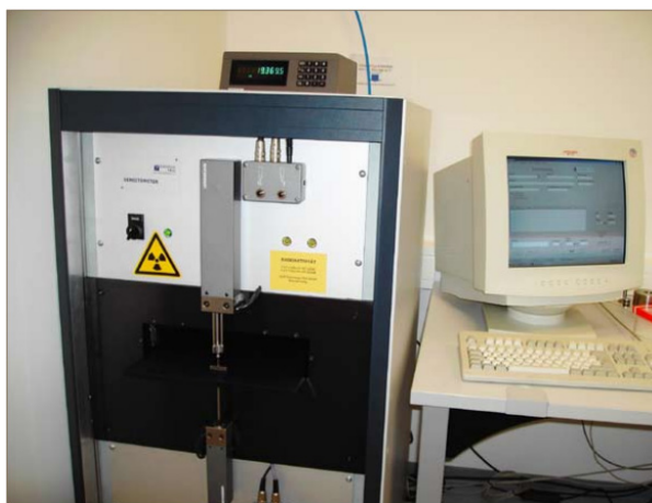
Рисунок 5.13 – Густинемір, що використовується для спечених деталей
