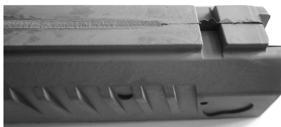
Рисунок 4.24 – Зображення шва від прес-форми на деталях ІЛП:
