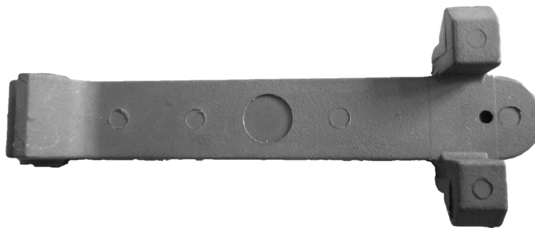
Рисунок 4.27 – Сліди від штовхачів системи ежекції
