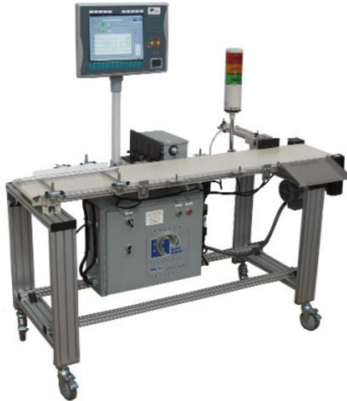
Рисунок 5.10 – Система неруйнівного контролю методом акустичного резонансу виробництва фірми «The MODAL SHOPINC» модель NDT-AUTO
