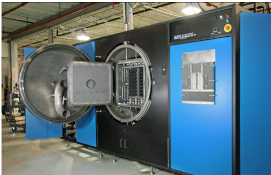
Рисунок 4.8 – Вакуумна піч серії GraphMIM 3045, Elnik Systems, оснащена графітовою ретортою
