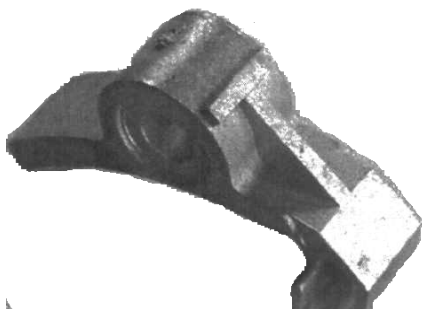
Рисунок 3.13 – Просте ребро для надання жорсткості та зв'язування двох ділянок компонента ІЛП
