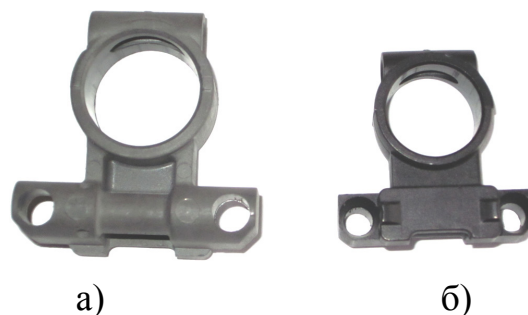
Рисунок 1.35 – Деталь до спікання (відливок) (а) і деталь після спікання (б)
