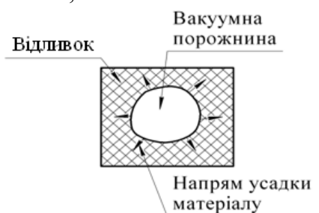
Рисунок 4.16 – Дефект, що може виникнути в зонах накопичення об'єму матеріалу
