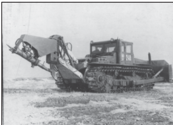
Рис. 1.11. Активный рыхлитель «СДР-1000» непрерывного действия с мощным ударным излучателем энергии на базе трактора ДЭТ-250
