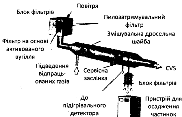
Рисунок 5.10 – Тунель фірми AVL для визначення маси викидів твердих частинок з ВГ дизелів
