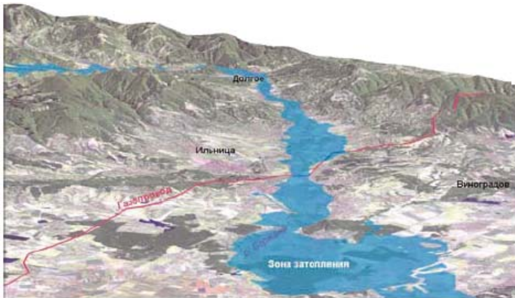
Рисунок 4.9 – Прогнозування зони затоплення 1% рівня забезпеченості в заплаві р. Боржава (ArcGIS ArcScene) [82]
