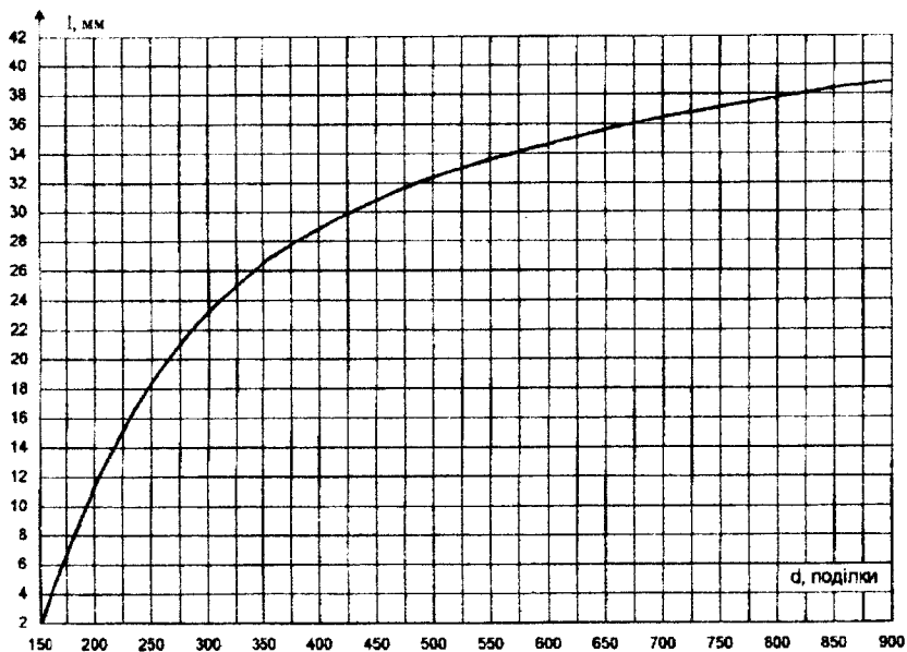
Рисунок 11 - Графік залежності переміщення шлунжера від поділок диска 1 для схеми № 1
