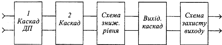
Рисунок 2.4 – Типова структурна схема операційного підсилювача
